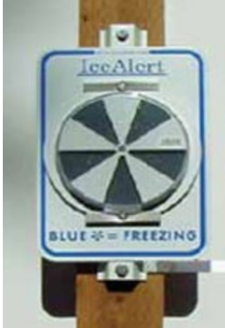
Figura 5.1 Monitor de termostato de alerta sobre el hielo.
