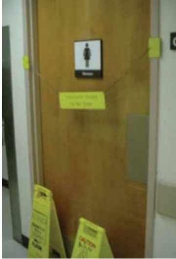
Figura 1.9 cadenas y señales de advertencia para bloquear el acceso a un cuarto durante su limpieza.
