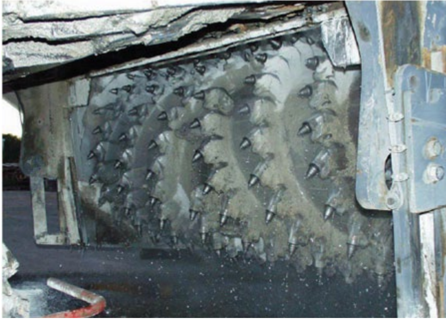
Figure 3. Refroidissement des dents par arrosage du tambour de fraisage. L'eau est ensuite mélangée au fraisat au fur et à mesure du rabotage (photographie NIOSH).
