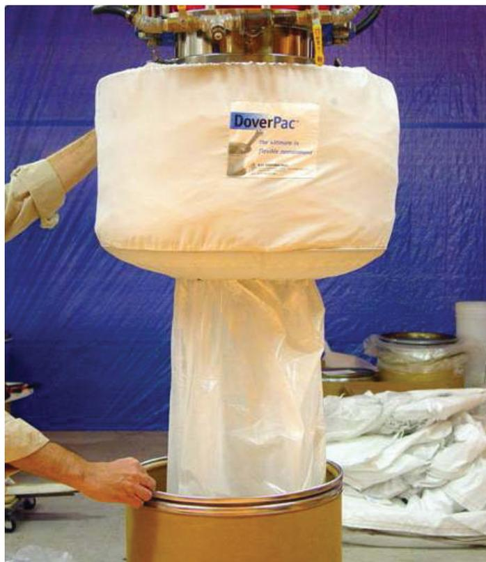
Figure 16. Système de déchargement continu de produit en doublures exploitant une alimentation continue en doublures pour sacs ajustées à l'écoulement du procédé pour isoler et confiner les émissions et le produit du procédé (utilisé avec l'autorisation d'ILC Dover.)
